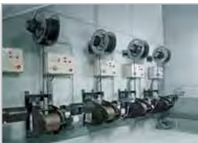
Treuil électrique pour les scènes et studios avec enrouleur de câble
